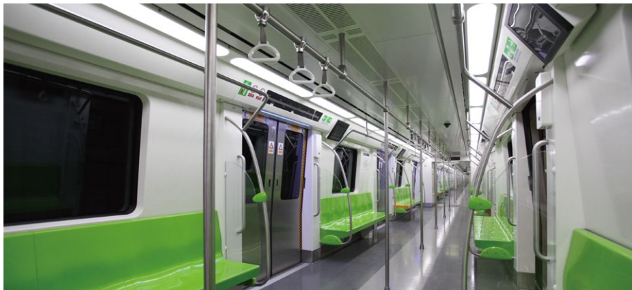
14号线列车客室照明系统升级为LED灯
