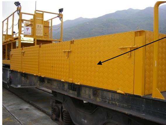
铰链式镶板外壳，700mm高，3mm厚钢板
