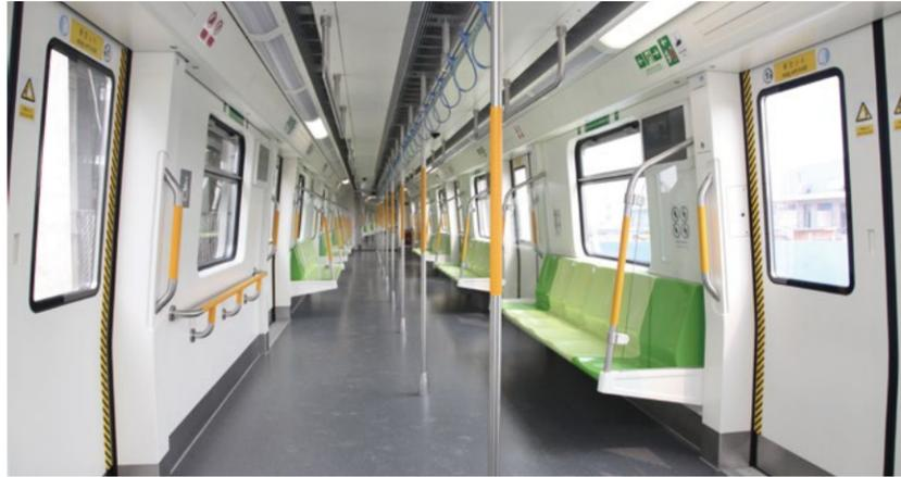
京港地铁16号线是北京轨道交通路网中首条使用8A型列车的线路，8A型列车比6B型列车运能提升76%，能够容纳更多乘客，提升运输效率
